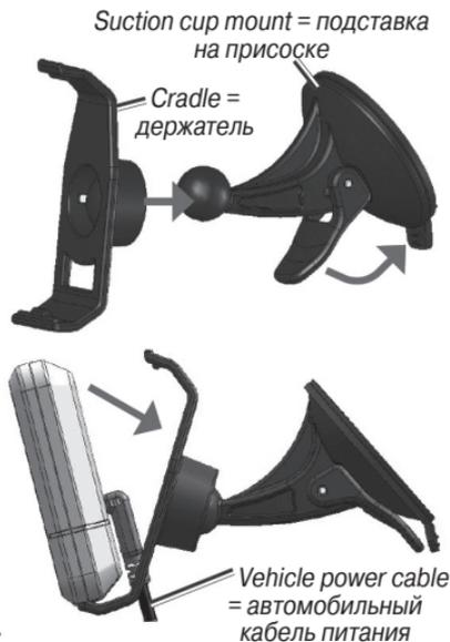
4. Вставьте нижнюю часть прибора *nivi* в подставку. Затем наклоните устройство *nivi* назад, чтобы оно встало на место (с щелчком).
